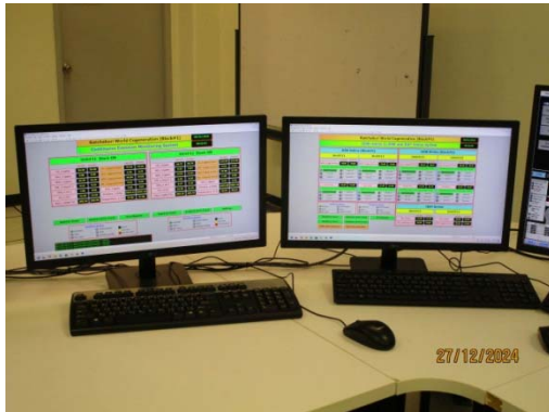
รูปที่ 1 หน้าจอ DCS ระบุค่าสัญญาณเตือนความผิดปกติจาก CEMs
